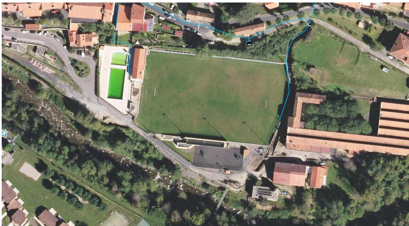
Pose de 222 mètres de canalisations en fonte DN 125 y compris pose de 2 poteaux incendie.
