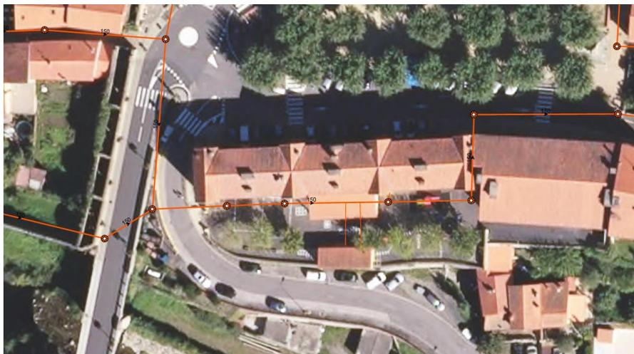
Remplacement 81 mètres de collecteur existant par une canalisation en PVC Ø200 avec reprise de 6 branchements.
